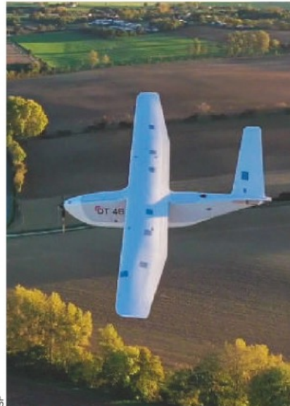
Delair DT46 en vol. Un engin de 25 kg à voilure fixe, capable de décoller à la verticale comme un hélicoptère.
