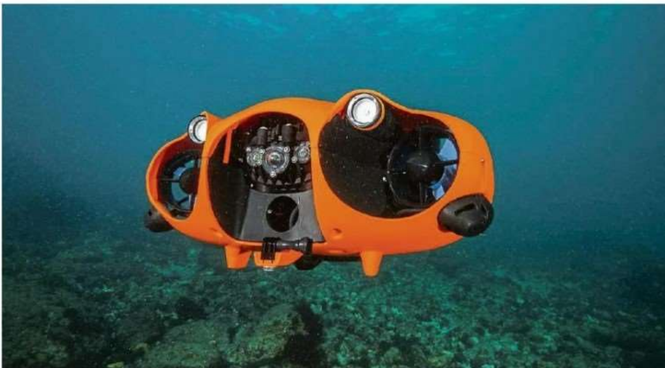
Notilo Plus a conçu un drone pour inspecter les coques de bateaux, les barrages et les réseaux d'éoliennes offshore. Photo Delair
